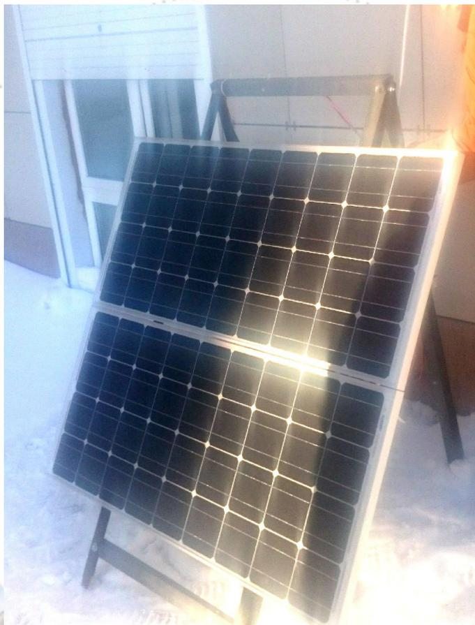
При помощи этой батареи и контроллера заряда, подходящего по напряжению и току, можно заряжать аккумуляторы емкостью от 20 до 100 А\*ч и напряжением 12 Вольт. Оптимальной емкостью аккумулятора для данной батареи является 50-60 А\*ч. При необходимости использования с аккумуляторами напряжением 24 В, нужно взять 2 солнечные батареи и соединить их последовательно.
