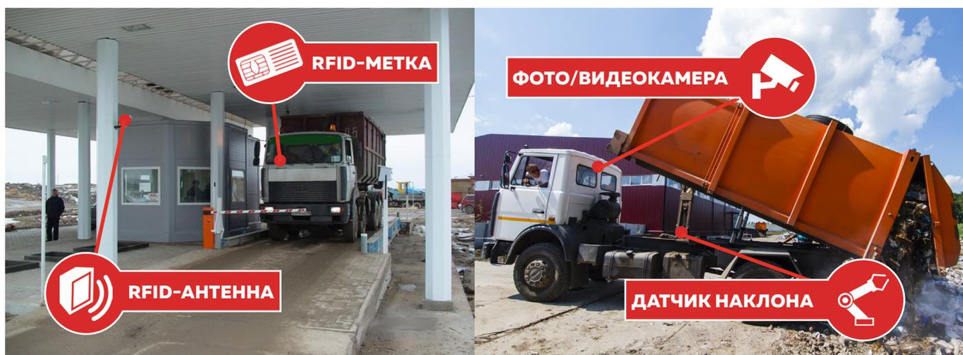
О каждом подъёме мусорного контейнера и свала его содержимого в бункер мусоровоза, в программное обеспечение SKIF будет поступать уведомление с измерительного устройства, обеспечивающего непрерывный контроль за состоянием изменения угла наклона относительно горизонтальной оси.
