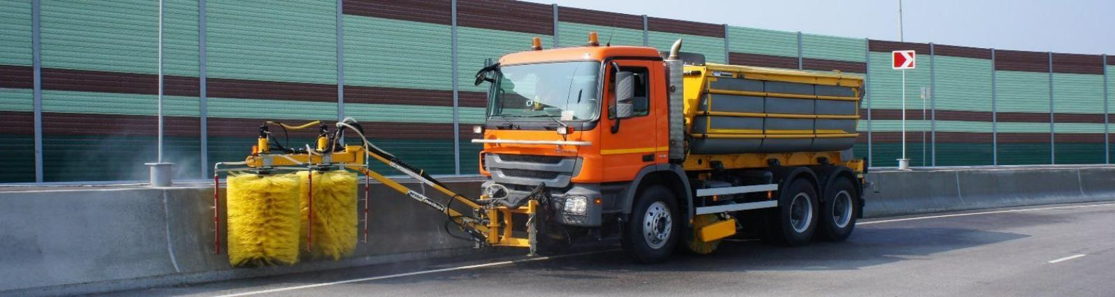
Для очистки твердых покрытий транспортных сооружений предназначены подметально-уборочные машины. Рабочий процесс подметально-уборочной машины складывается из подметания поверхности,
