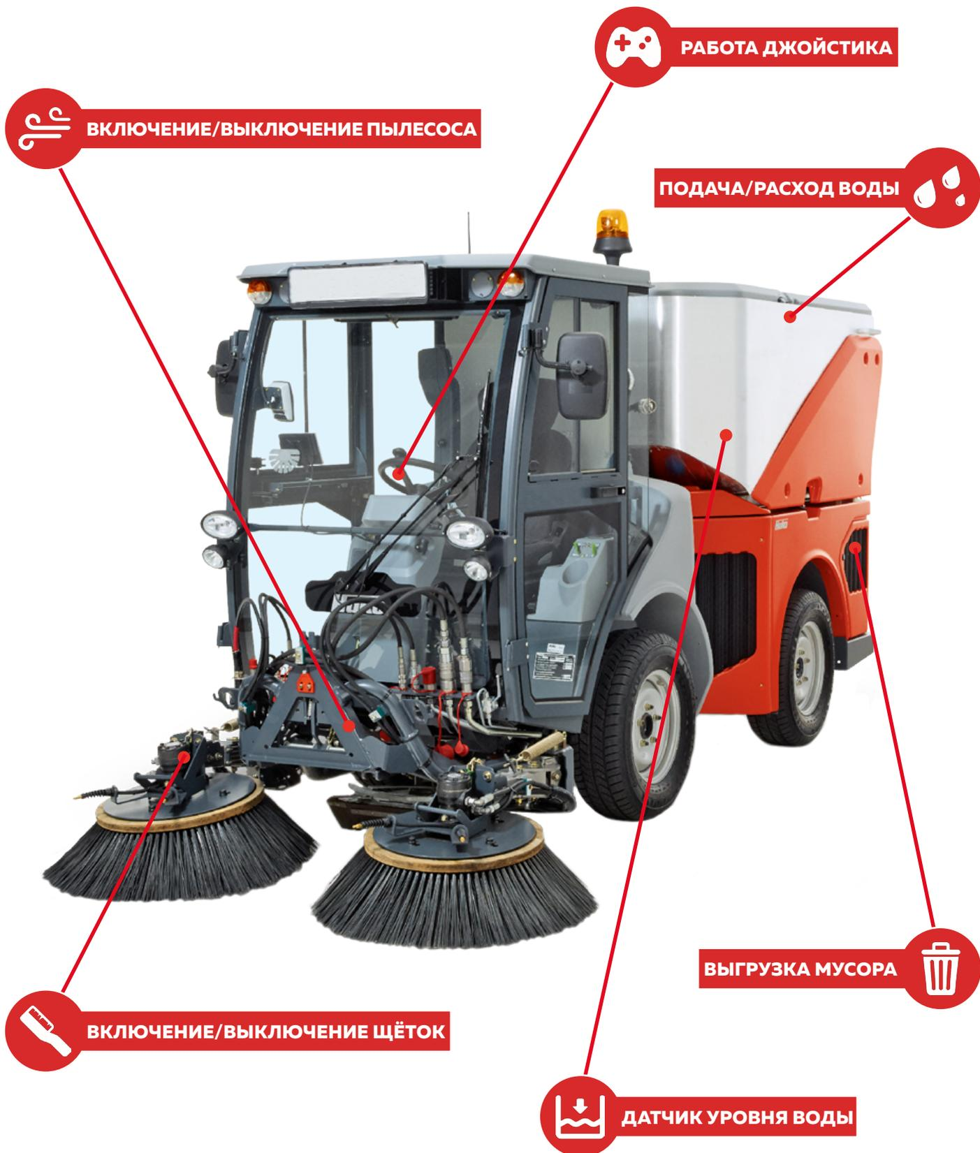
Дорожные вакуумные подметально-уборочные машины «Пылесос» применяются для очистки улиц в крупных городах от пыли, мелкого мусора, камней, находящихся на проезжей части дороги и загрузки их в приемный самосваль- ный бункер.
