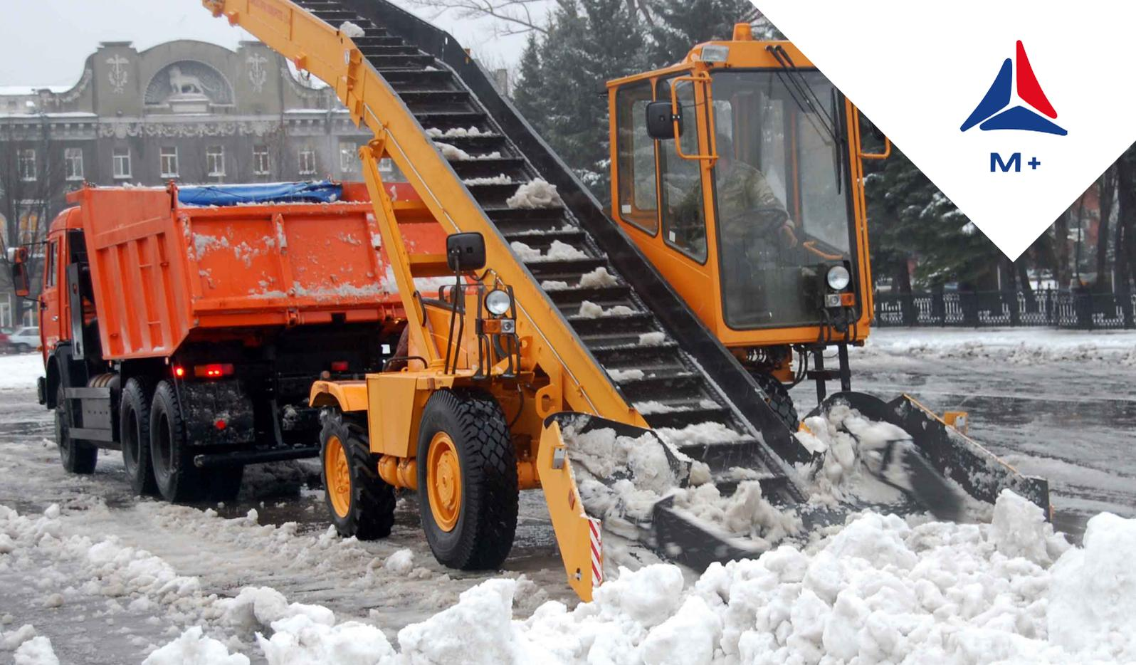
Ликвидация снежных валов и перемаётов так же производится снегоуборочной техникой с рабочим вращающимся органом – шнеком, которая перемещает снежные массы и осуществляет их непосредственный выброс на удаленное расстояние от дороги.
